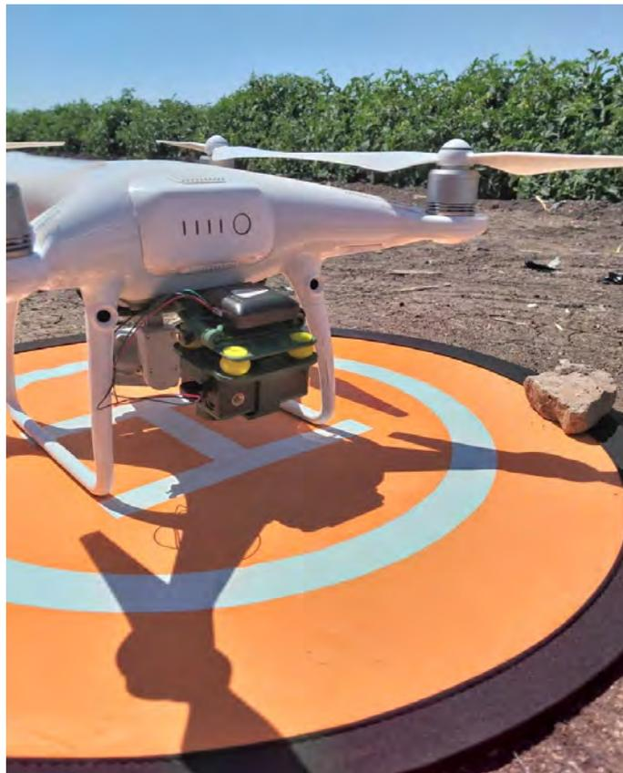
**Figura 3.4.** Phantom 4 Pro con cámara espectral anclada. Fuente: Fotografía propia.
