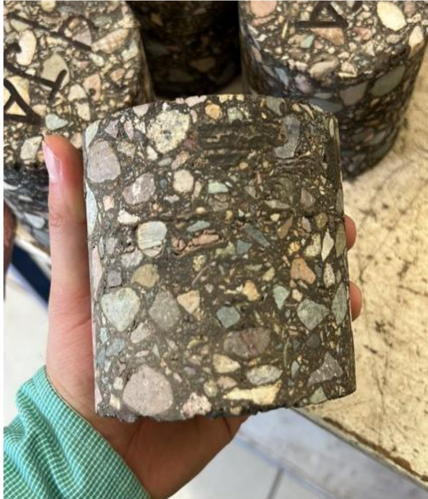
Fig. 16. Núcleo de 4" con geomalla.
