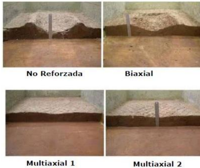
Fig. 8. Reforzamiento de la subrasante con geomalla triaxial y biaxial.
