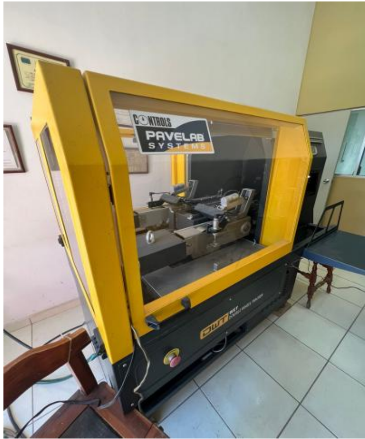
Fig. 22. Rueda Cargada de Hamburgo en funcionamiento.
