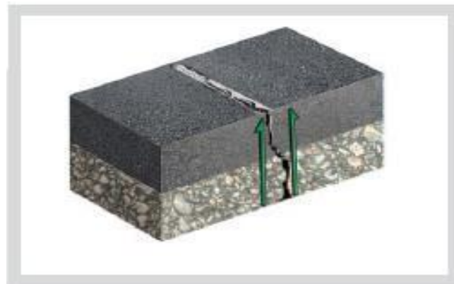
Fig. 12. Las grietas se reorientan con la superficie en la sobrecarpeta no reforzada (TENSAR, 2020).
