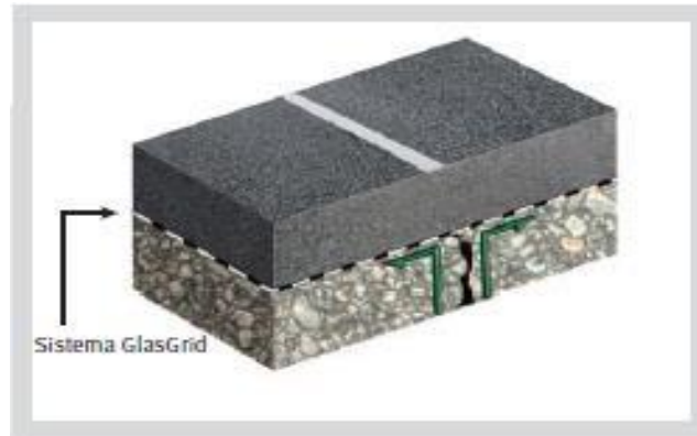
Fig. 11. Las grietas migran hacia la sobrecarpeta reforzada con geomalla (TENSAR, 2020).
