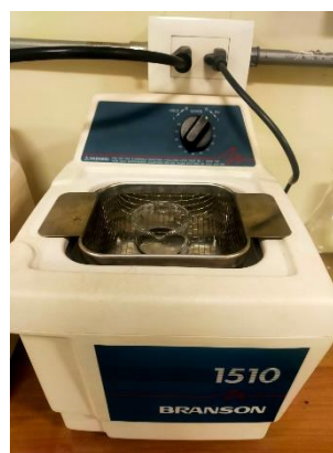
Figura 20. Baño ultrasónico Branson modelo 1510.
