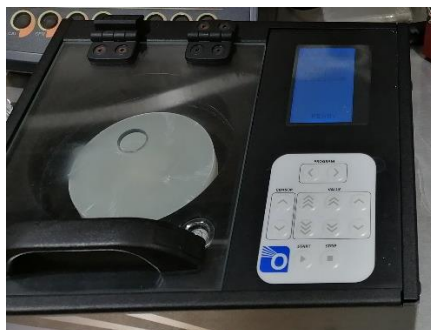
Figura 22. Spin – Coater de la marca Ossila
