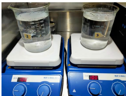
Figura 29. Evaporación del solvente para la obtención de polvos.
