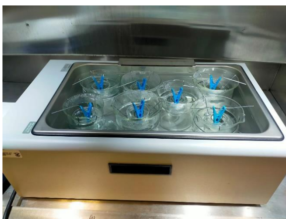
Figura 27. Arreglo de CBD, para el crecimiento de las películas
