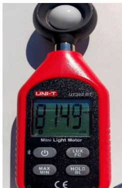
Figura 36. Luxómetro de la marca UNI – T modelo UT383 – BT .
