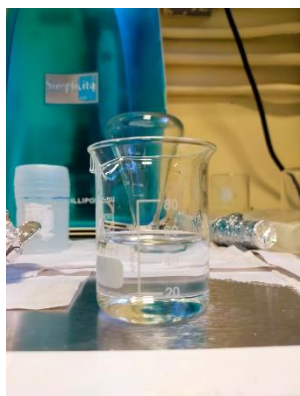
Figura 18. 50\text{ ml} de metanol a 0.06\text{ M} de AcZn .
