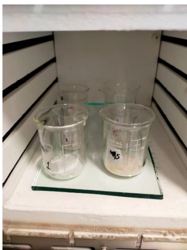
Figura 31. Polvos en vasos de precipitados dentro de la mufla para tratamiento térmico.
