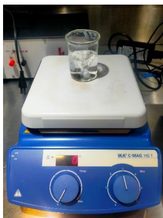
Figura 21. Agitador magnético con calefacción y placa calefactora IKA modelo C-MAG-HS .
