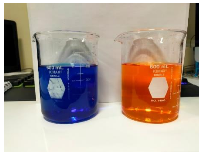
Figura 32. 400 ml de agua desionizada a 10 ppm : Azul de metileno y naranja de metilo.
