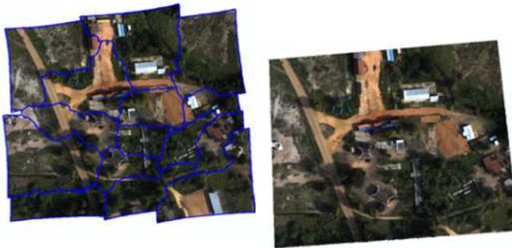
(a) Ejemplo de partes de imágenes para la construcción del ortomosaico.
