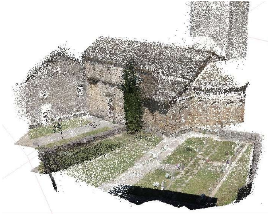
Figura 2.10: Ejemplo Nube de Puntos Densa (Lárrede de, 2020)
