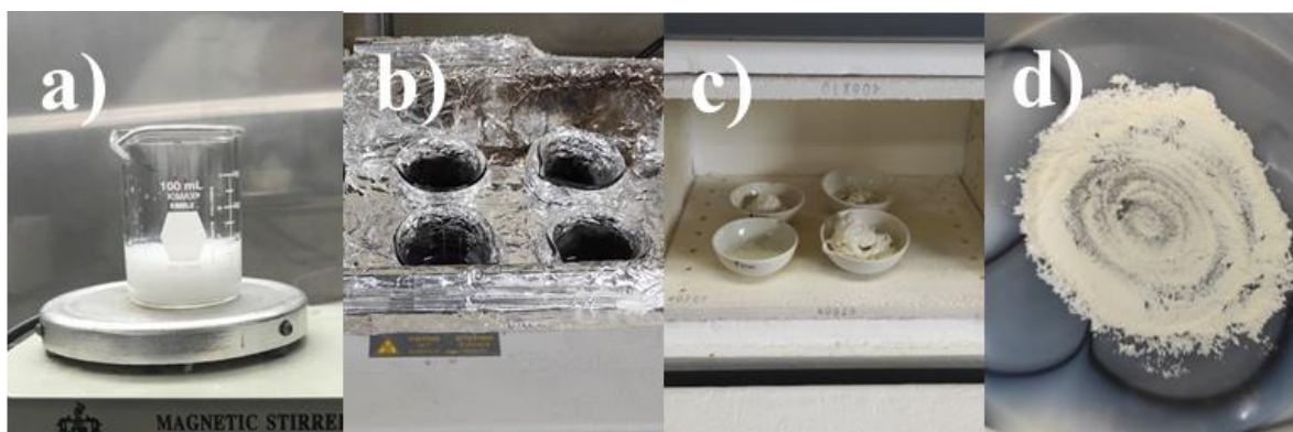
Figura 3.4. Procedimiento para la síntesis química de las NPs de ZnO: a) Solución de agua y precursor, b) evaporación de la solución en baño de agua a 60 °C, c) tratamiento térmico a 400 °C y d) triturado del material con mortero.
