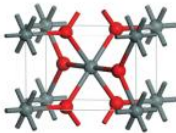
Figura 2.7. Estructura del SnO 2 en su fase rutilo tetragonal.
