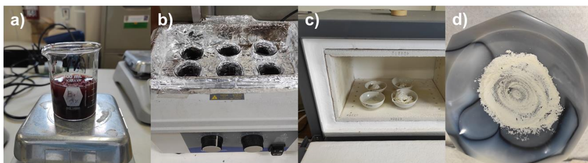
Figura 3.5. Procedimiento para la síntesis verde de las NPs de ZnO: a) Solución de extracto y precursor, b) evaporación de la solución en baño de agua a 60 °C, c) tratamiento térmico a 400 °C y d) triturado del material con mortero.
