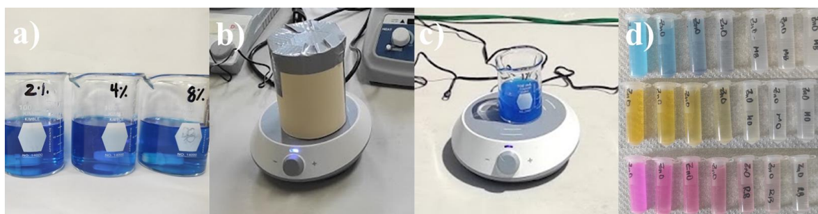
Figura 3.10. Degradación fotocatalítica de colorantes bajo irradiación UV: a) Soluciones de colorante, b) agitación en la oscuridad, c) exposición a irradiación UV y d) muestras tomadas a diferentes tiempos.
