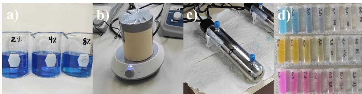
Figura 3.9 Degradación fotocatalítica de colorantes bajo irradiación UV: a) Soluciones de colorante, b) agitación en la oscuridad, c) exposición a irradiación UV y d) muestras tomadas a diferentes tiempos.
