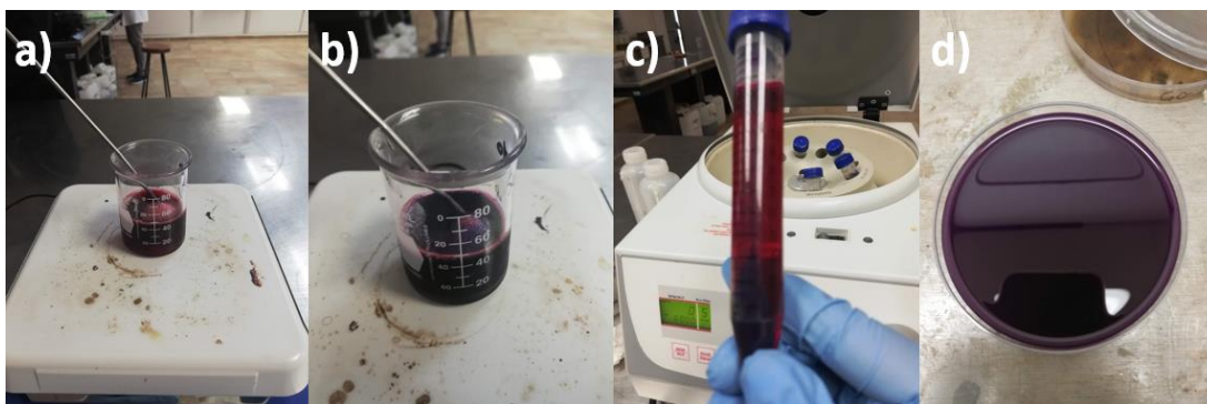
Figura 3.3. Procedimiento para la síntesis verde de las NPs de SnO 2 : a) uso del extracto, b) tratamiento térmico de la solución con agitación, c) lavados con centrifuga y d) secado del material en una cajita Petri.
