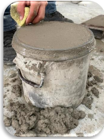
Figura 28. Prueba de masa volumétrica en concreto.
