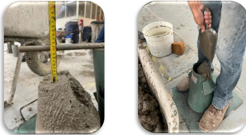
Figura 27. Procedimiento para prueba de revenimiento al concreto.
