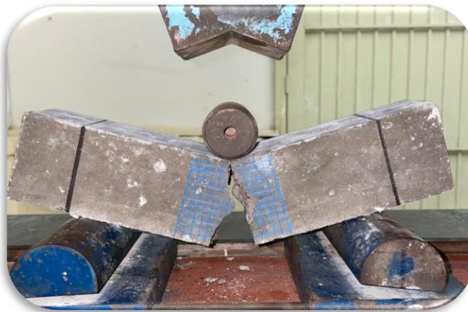
Figura 32. Ensayo a flexión de vigas de concreto ordinario.
