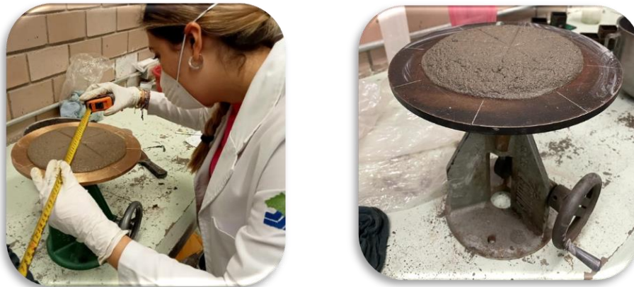
Figura 22. Proceso de la prueba de fluidez.
