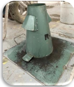
Figura 16. Equipo para prueba de revenimiento.
