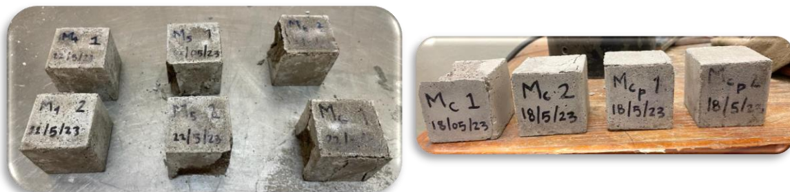
Figura 25. Muestras de mortero con caucho y MK después del ensayo a compresión.
