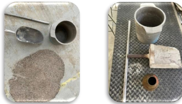
Figura 7. Equipo utilizado para el ensayo de masa volumétrica en agregados.
