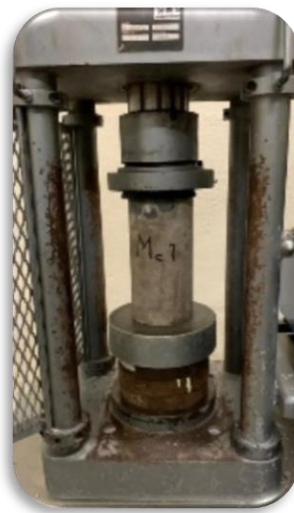
Figura 30. Prueba de resistencia a la compresión en cilindro de concreto.
