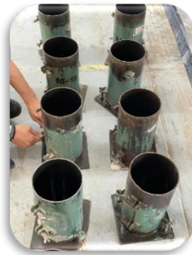
Figura 17. Moldes para cilindros de 15X30 cm.
