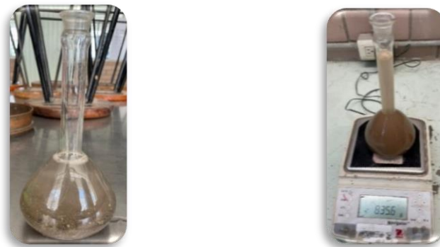
Figura 10. Matraz con agregado fino y agua para ensayo de densidad en arenas.
