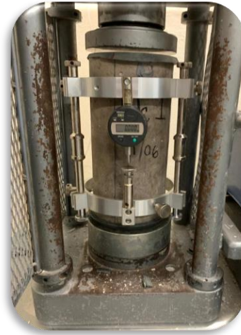
Figura 38. Prueba de módulo elástico en cilindro de concreto.
