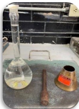
Figura 8. Equipo de matraz, pisón y cono para la prueba de densidad en agregados finos.
