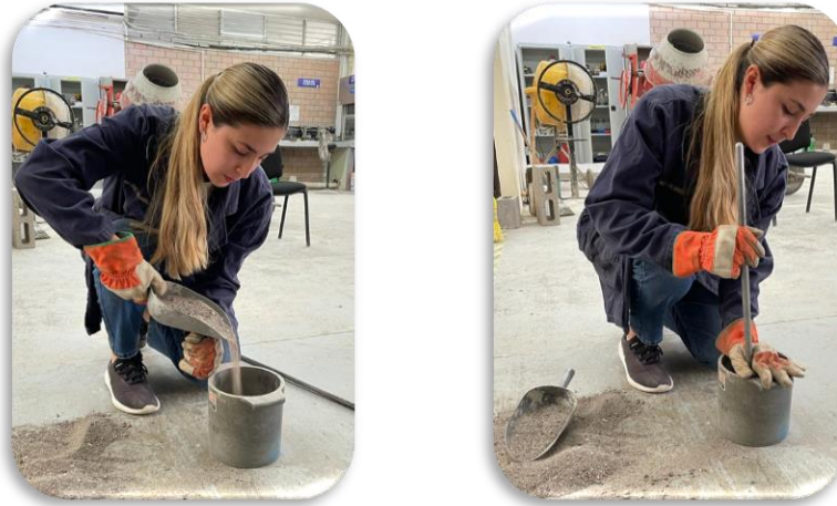
Figura 20. Procedimiento de la masa volumétrica suelta y compacta.
