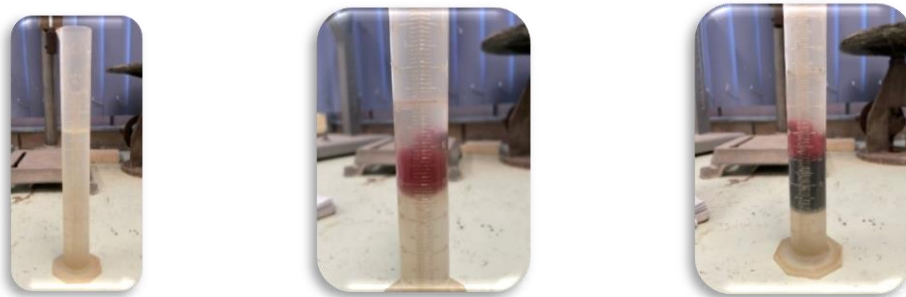
Figura 12. Prueba para conocer densidad del caucho.
