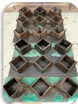
Figura 15. Moldes para cubos de mortero de 5x5x5 cm.
