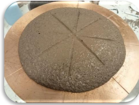
Figura 3. Mortero con fluidez de 115%.
