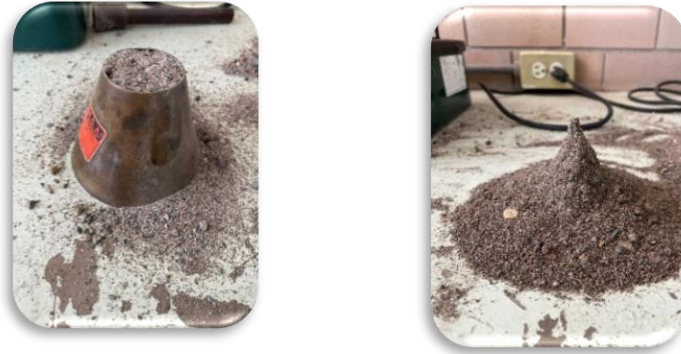
Figura 9. Prueba del cono para confirmar que la arena se encontraba en estado SSS.
