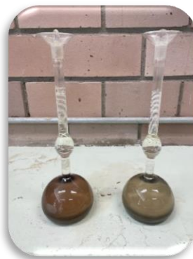
Figura 13. Prueba de densidad a MK y cemento
