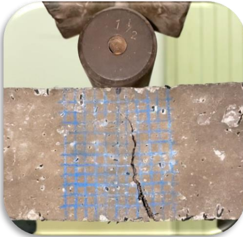
Figura 33. Fractura en viga de concreto con MK y caucho tras ensayo a flexión.
