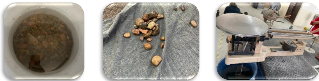
Figura 11. Grava saturada en agua, secado de grava para su estado SSS, balanza para prueba de densidad a gravas.
