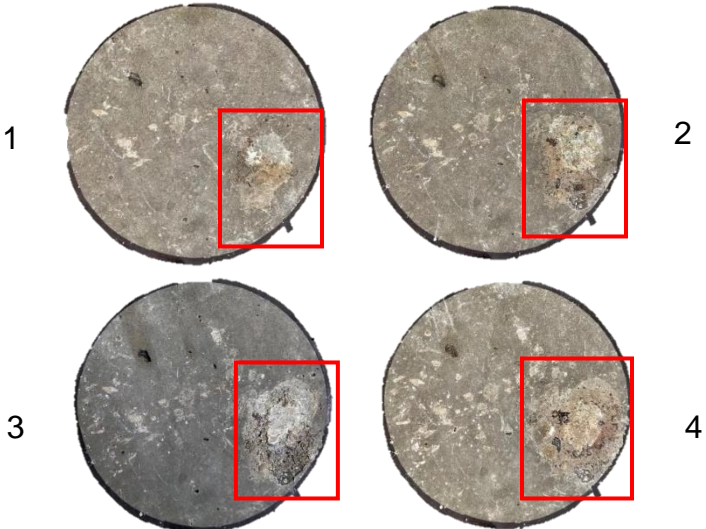
Figura 39. Prueba de impacto en concreto ordinario.
