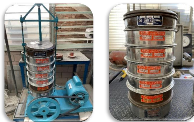
Figura 6. Aparato e instrumentos para realizar el ensayo de granulometría a arenas y gravas.
