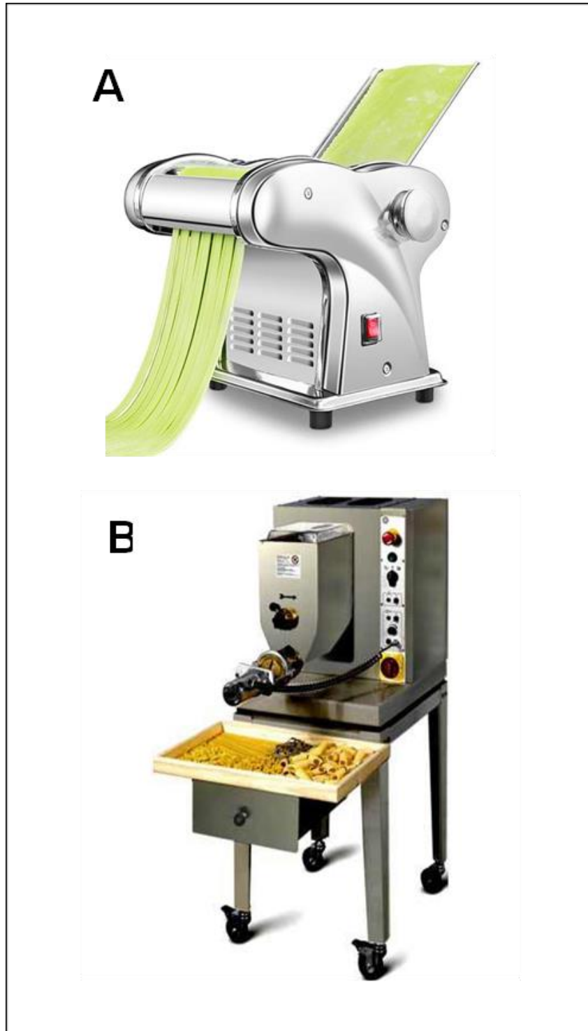
Figura 4. Métodos de elaboración de pastas: A. Método de laminación; B. Método de extrusión. (Hou y col 2010; Bordoloi y Ganguly 2014).
