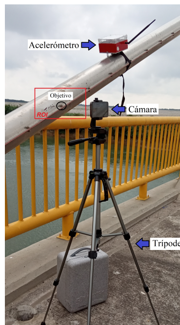
Figura 5.9: Instrumentación durante pruebas en campo.
