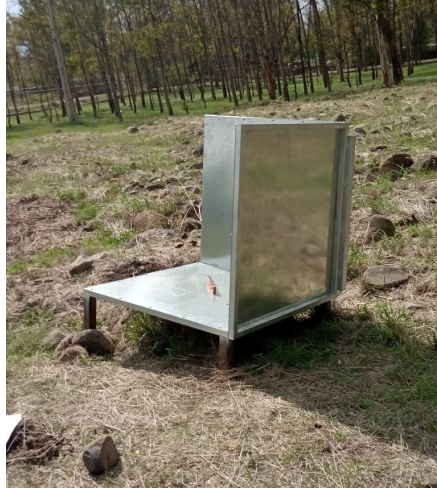
Figura 3.9: Antena reflejante elaborada para el experimento controlado de validación.
