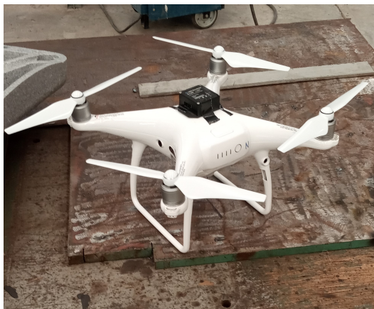
Figura 6.2: UAV con acelerómetro montado en parte superior.
