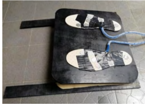
Figura 3.3: Sistema de medición plantar para distintas inclinaciones con 6 sensores. Adaptado de Ang et al. (2018).
