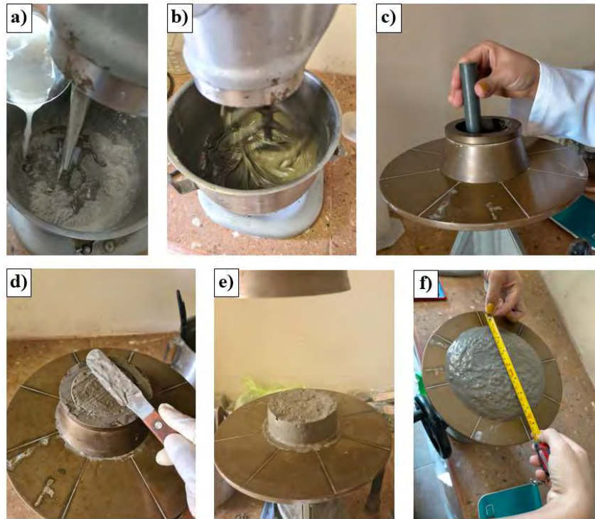
Figura 3-17. Proceso para la elaboración de la prueba de fluidez, a) se colocaron los materiales en la mezcladora, b) se mezcló, c) colocó en el cono con espátula, d) se llenó el cono y se enrasó, e) en reposo y f) se midieron los diámetros.
