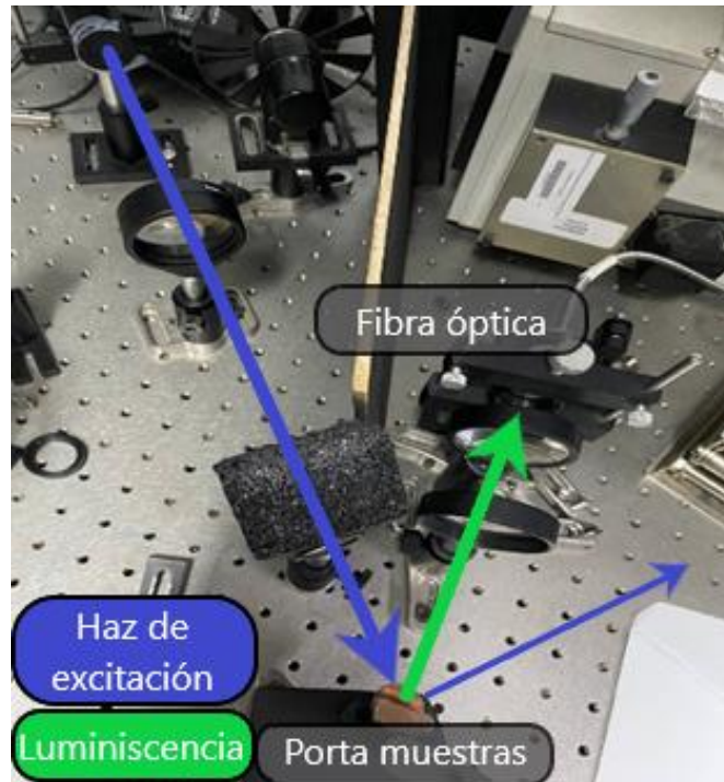
Figura 4-4 Arreglo experimental de PL utilizado para las mediciones
