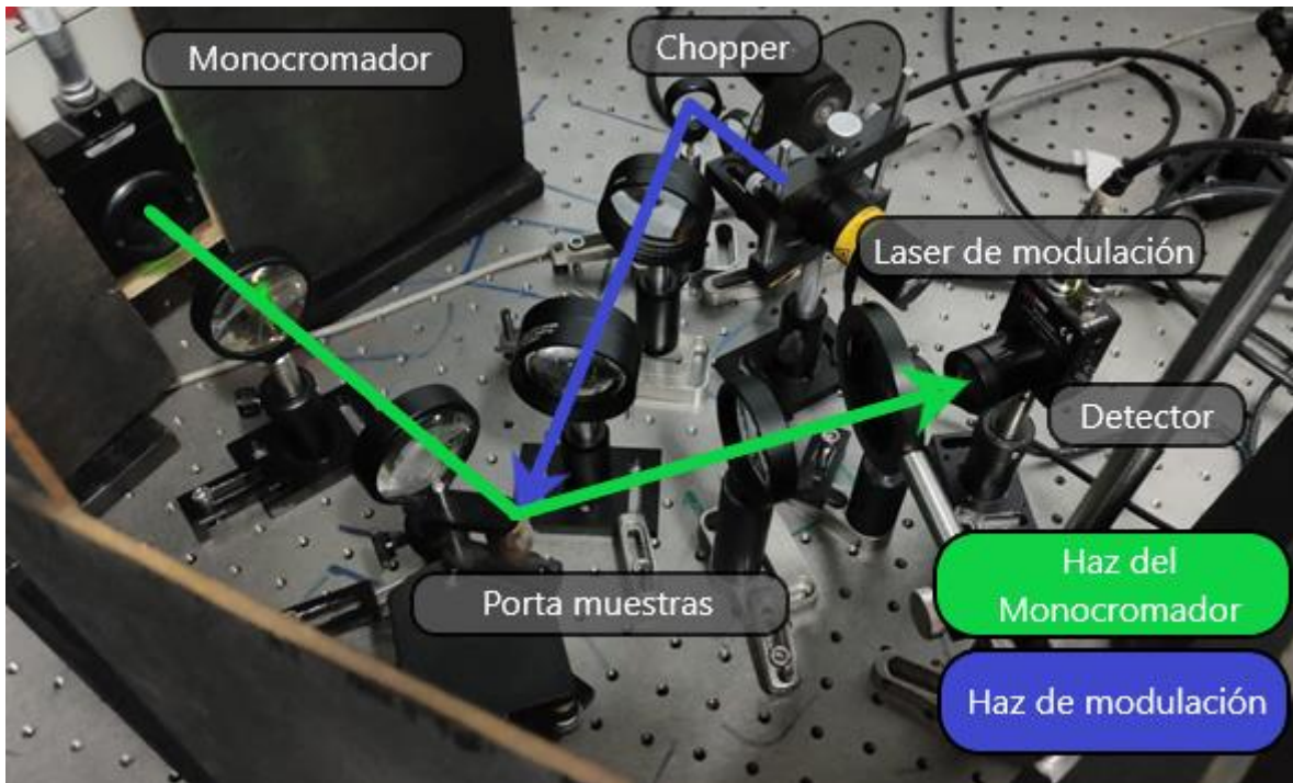
Figura 4-2 Arreglo experimental de PR utilizado para las mediciones.
