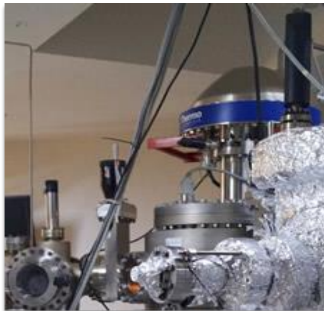
Figura III-2 fotografía del sistema MBE del laboratorio del Cinvestav
