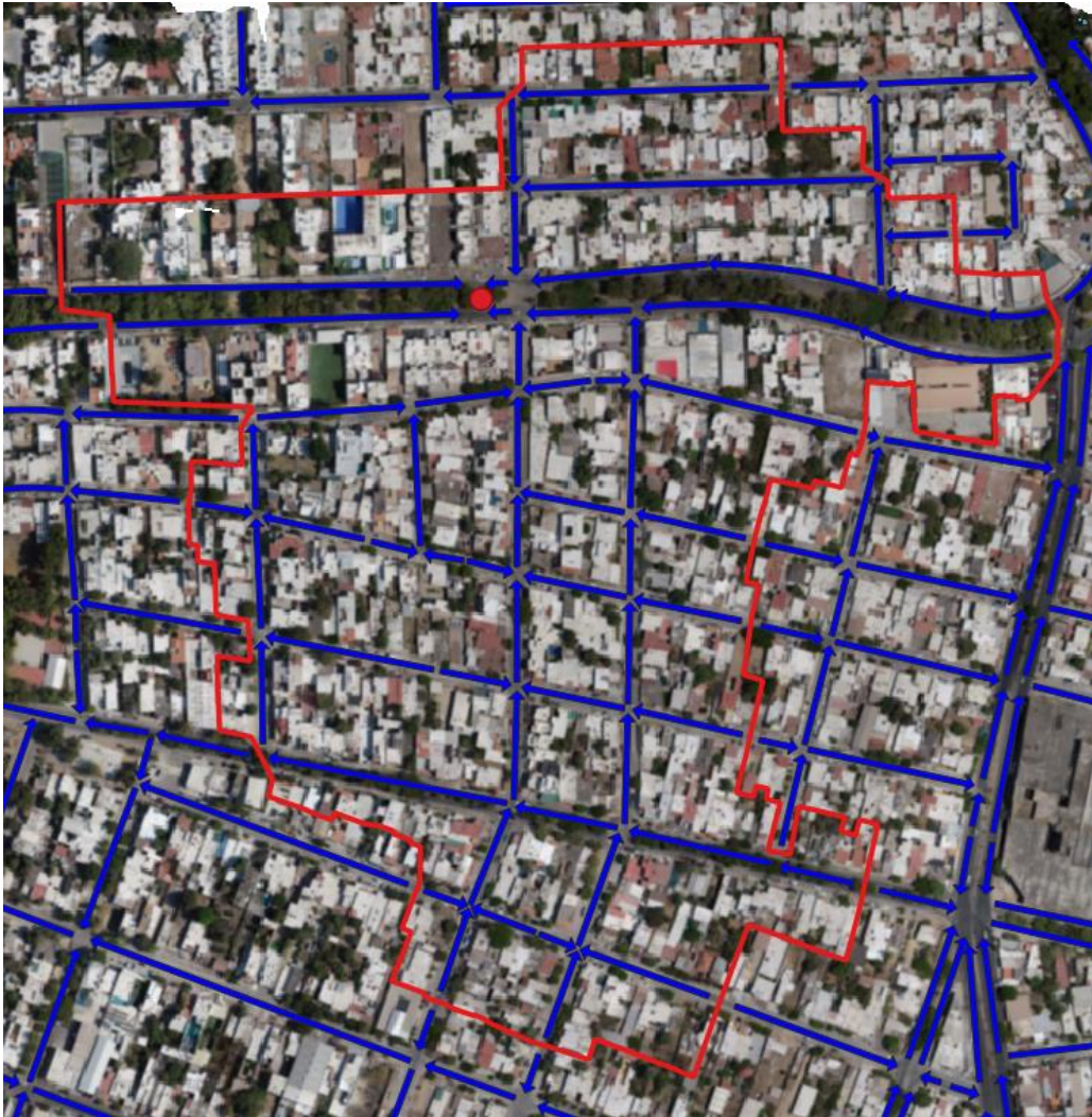
Figura 26. Delimitación de la cuenca con sus respectivas direcciones de flujo.
