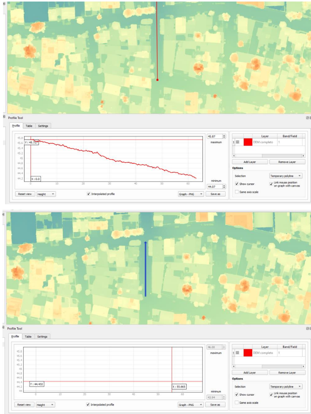
Figura 22. Trazo de las direcciones de flujo.
