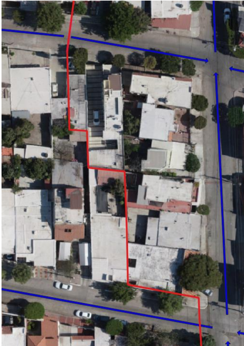
Figura 25. Delimitación de la cuenca tomando en cuenta los límites de las propiedades.
