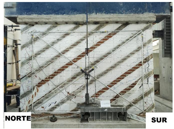
c) Agrietamiento del espécimen MCT-FV30 en el ciclo 11
