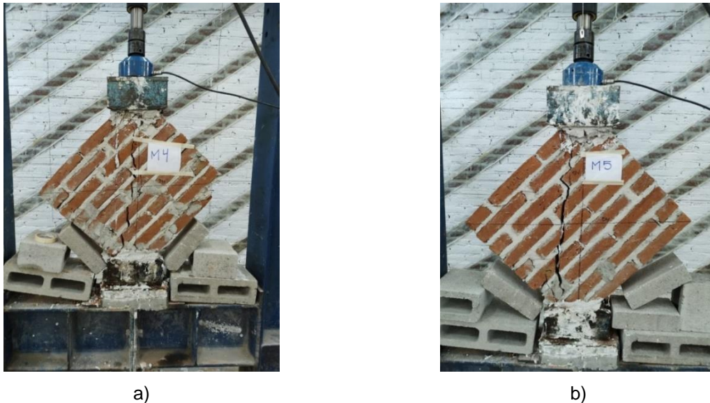
Figura 10. Resistencia a compresión diagonal en muretes a) Ensaye, b) Modo de falla
