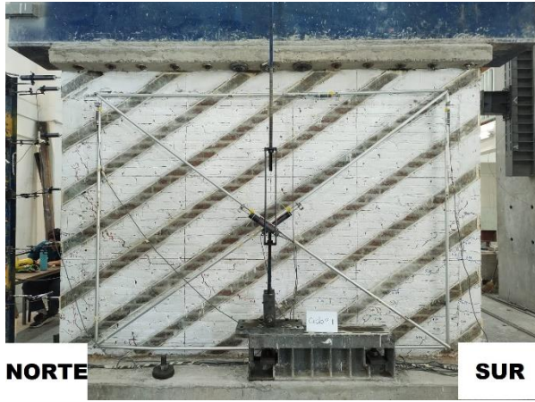
b) Agrietamiento del espécimen MCT-FV30 en el ciclo 9
