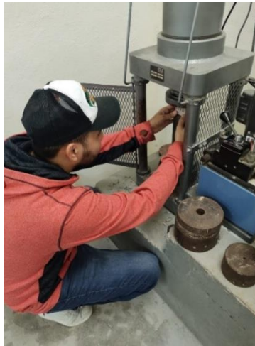
Figura 6. Prueba a compresión de cubos de mortero
