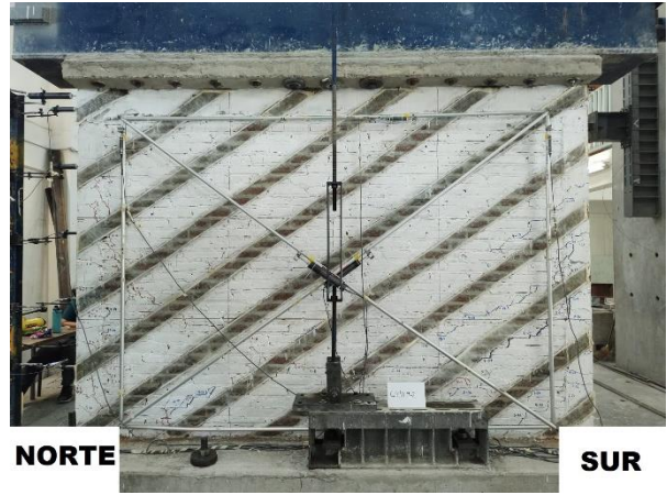
b) Agrietamiento del espécimen MCT-FV30 en el ciclo 9
