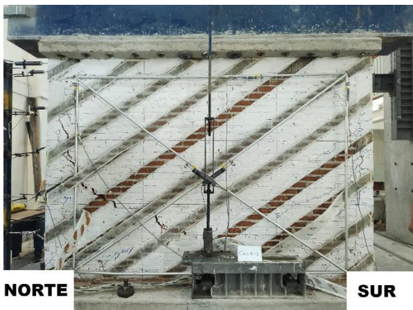
c) Agrietamiento del espécimen MCT-FV30 en el ciclo 11
