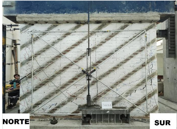
b) Agrietamiento del espécimen MCT-FV30 en el ciclo 9
