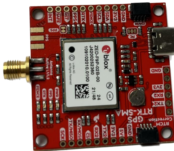
Figura 3. Receptor GNSS de bajo costo, modelo ZED-F9P; fabricante U-Blox.
