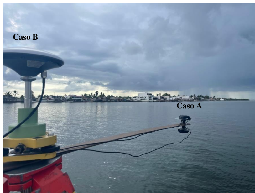
Figura 20. Arquitectura para la toma de datos GNSS con receptores y antenas de bajo costo.
