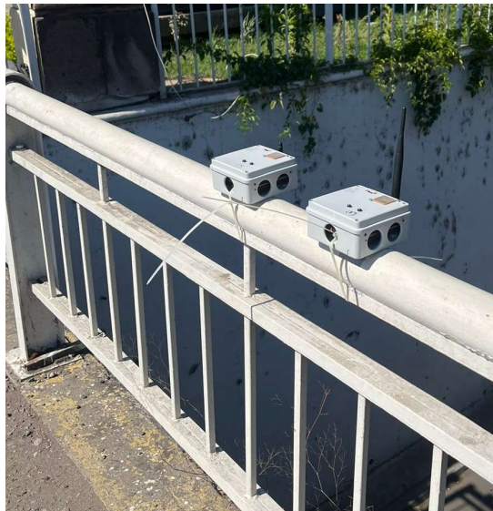
Figura 32.- Colocación de acelerómetro de bajo costo.
