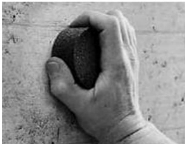
Figura 8.- Preparación de superficie a ensayar. Fuente: [24]
