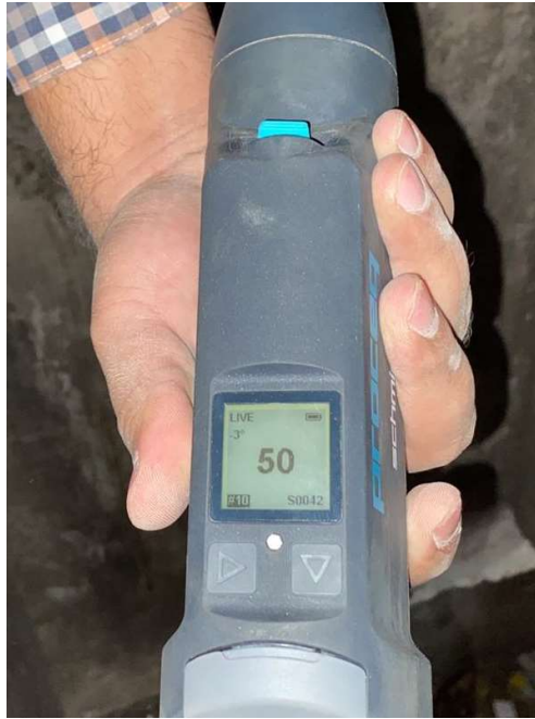
Figura 24.- Número de rebote registrado en esclerómetro.
