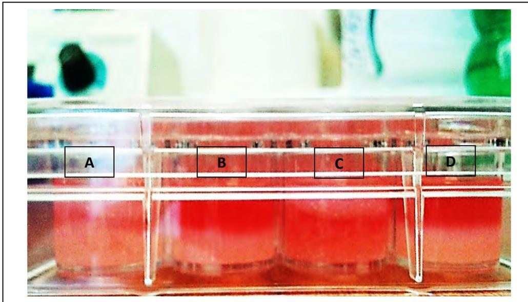
**Figura. 33. Determinación de la resistencia de los hidrogeles a la tensión superficial generada por el medio de cultivo. A. Hidrogeles de 10 mg/ml, B. Hidrogeles de 20 mg/ml, C. Hidrogeles de 15 mg/ml y D. Hidrogeles de 20 mg/ml.**
