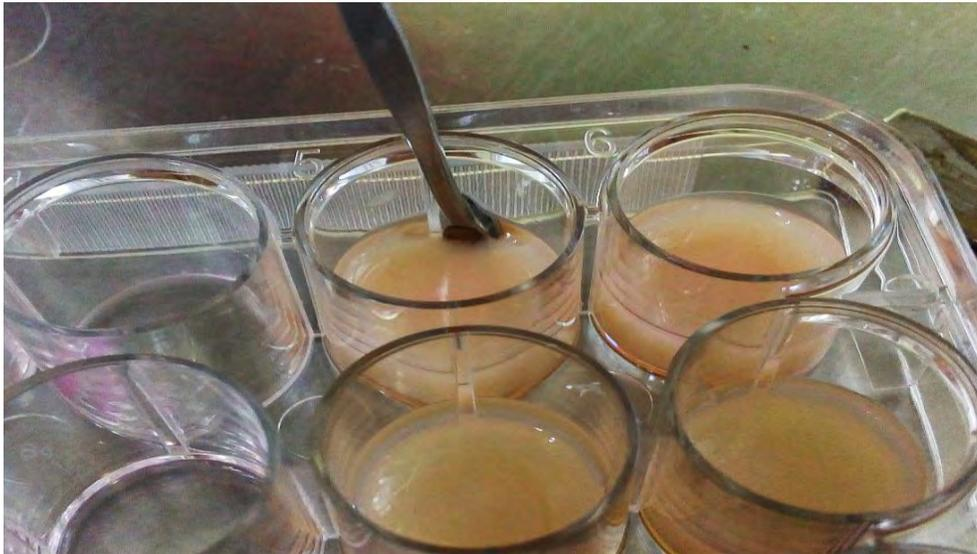
**Figura 39. Desprendimiento del hidrogel de la caja de cultivo tras su fijación.**
