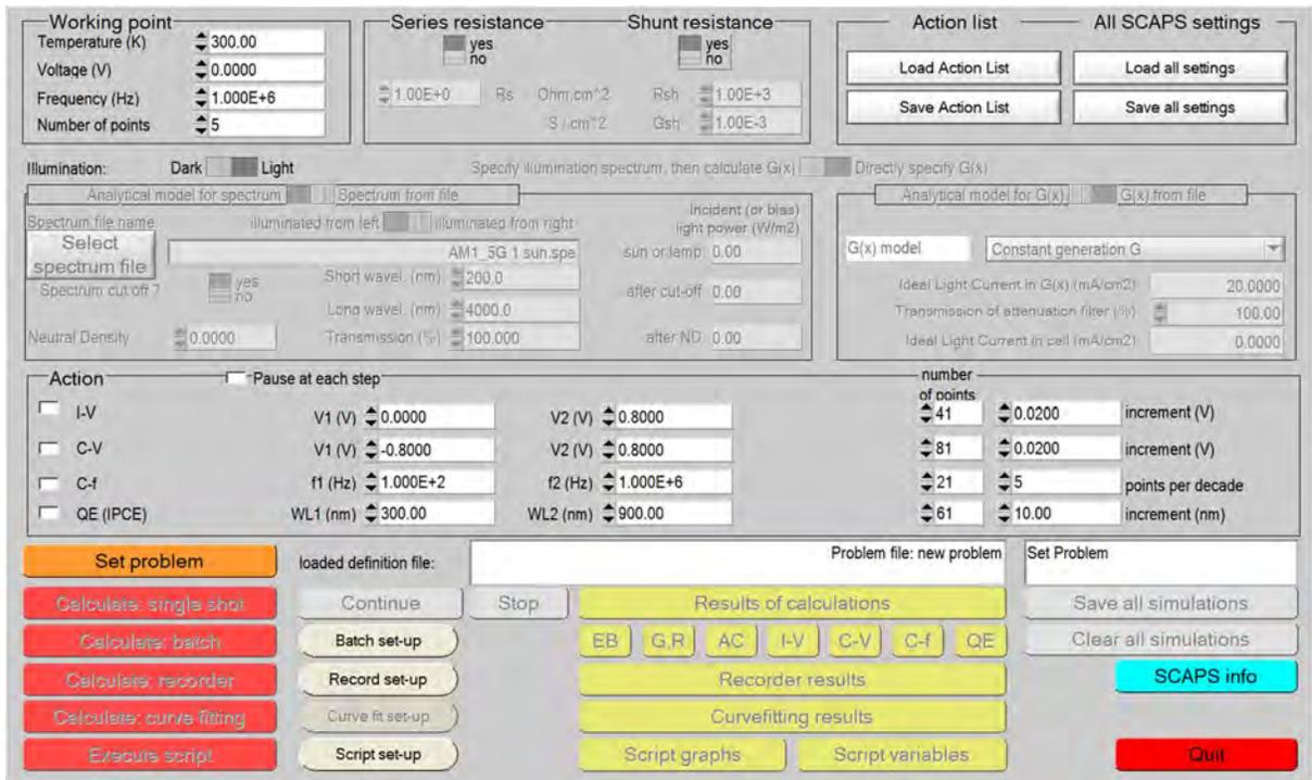
Figura 15. Pantalla principal de configuración del punto de trabajo y condiciones de análisis del software SCAPS
