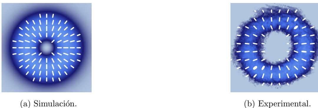
Figura 4.3: Haz LG polarizado radialmente. (a) simulación; (b) experimental (conurrencia=0.9132).
