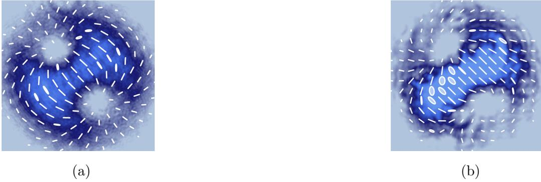
Figura 4.47: Reconstrucción de polarización del haz MGHV. (a) Sin incidir sobre la muestra; (b) incidiendo sobre la muestra (Fig. 4.44).
