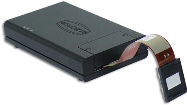
Figura 3.2: SLM Holoeye modelo PLUTO-2.1.
