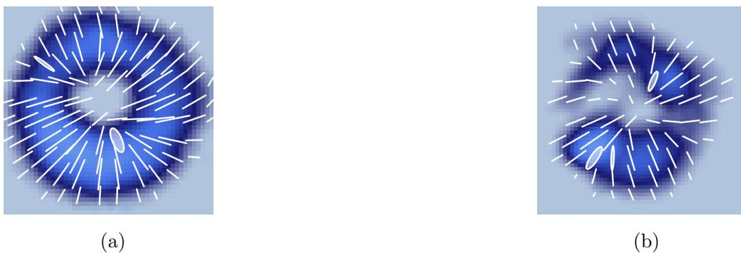
Figura 4.33: Reconstrucción de polarización con polarización radial incidente. (a) Sin incidir sobre la muestra; (b) incidiendo sobre la muestra (Fig. 4.30).
