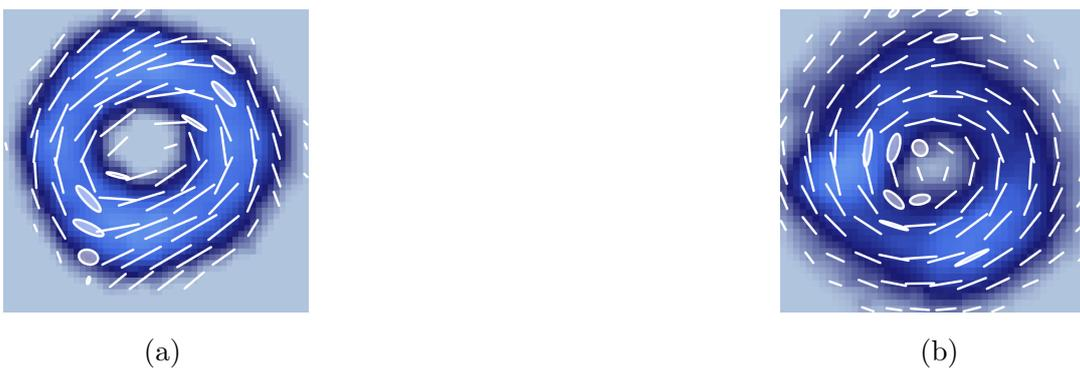
Figura 4.43: Reconstrucción de polarización con polarización acimutal incidente. (a) Sin incidir sobre la muestra; (b) incidiendo sobre la muestra (Fig. 4.37).
