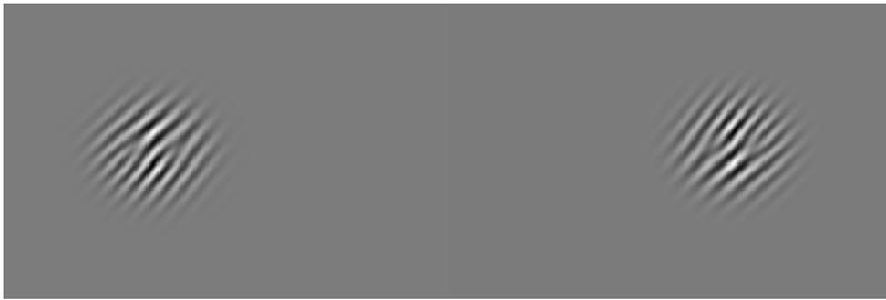
Figura 2.12: Hologramas codificados en el SLM para generar un haz Mathieu - Gauss helicoidal vectorial;  $a = 1$ ,  $e = 0.9$ ,  $m = 2$  y  $k_t = 3$ . El holograma en la parte izquierda es ortogonal al de la parte derecha, la superposición de ellos genera un haz vectorial.
