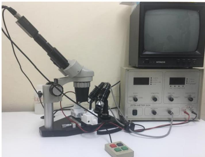
**Figura 11:** Zetámetro 3.0+ que se usará para medir la movilidad electroforética.
