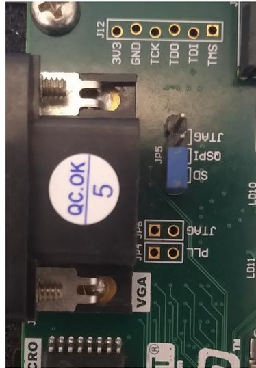
**Figura B-1.:** Configuración de arranque en ZYBO.
