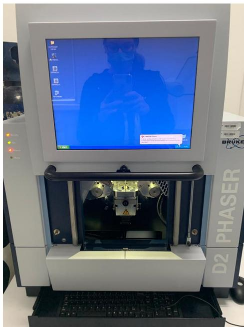
Fig. 7. Difractómetro de rayos X marca Bruker D2 Phaser.
