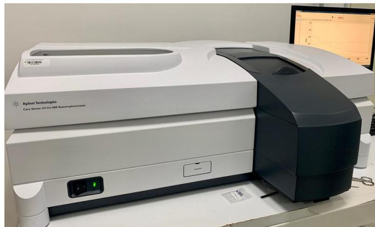
*Fig. 12. Espectrofotómetro Cary 5000 UV-Vis-NIR.*
