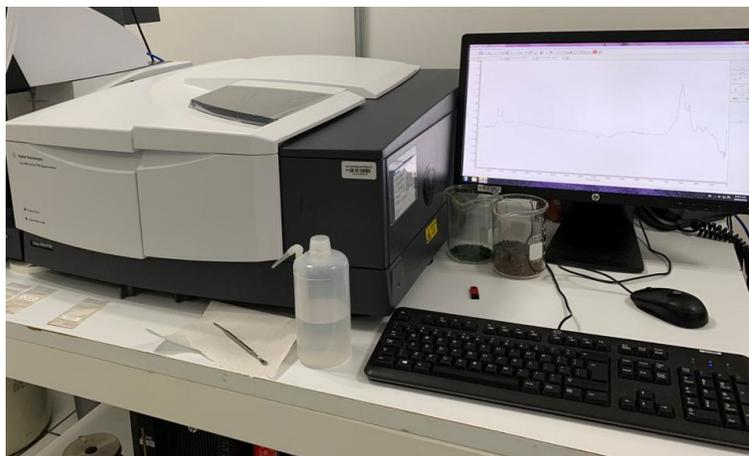
*Fig. 8. Espectrofotómetro FTIR Cary 670.*
