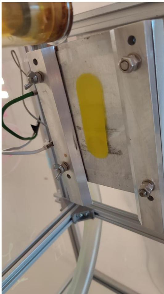
*Figura 20.- Fotografía de la película sintetizada en los sustratos sobre la placa de calentamiento.*
