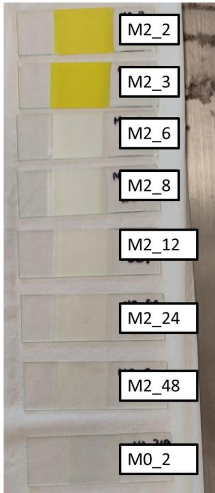
*Figura 28.-Set de películas de perovskitas con la variación de la relación molar CsCl:PbBr<sub>2</sub>.*
