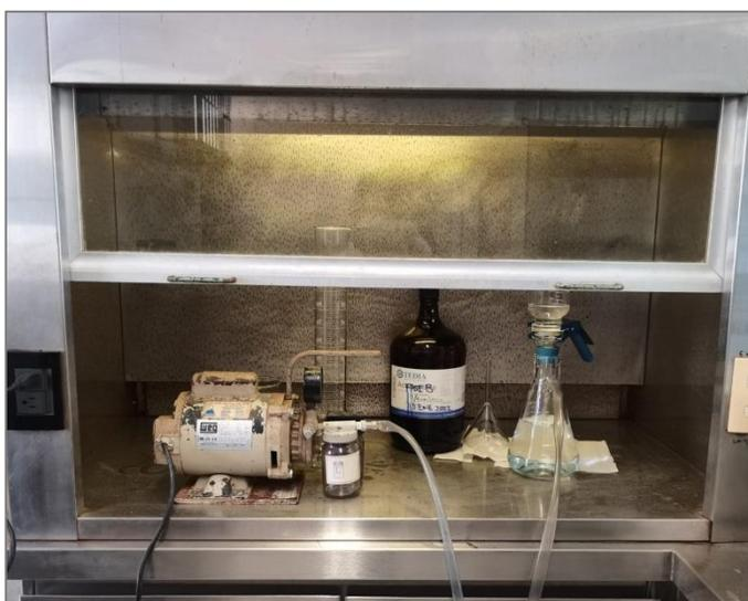
**Figura 8.** Preparación y filtración a vacío de fases móviles y solución acuosa de piridina.
