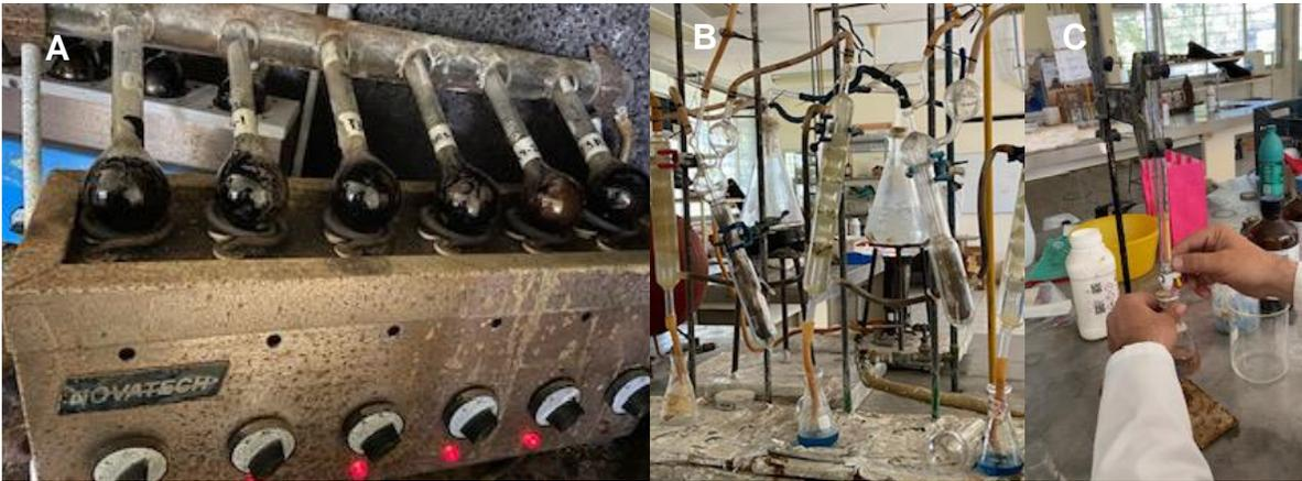
**Figura 13.** Digestión de las muestras (A). Destilación de muestras (B). Titulación con ácido sulfúrico al 0.1 N (C).
