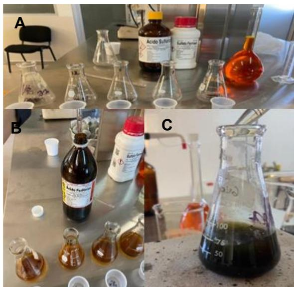
**Figura 16.** Muestra de suelo (A). Incorporación de dicromato de potasio (B). Titulación con sulfato ferroso(C).
