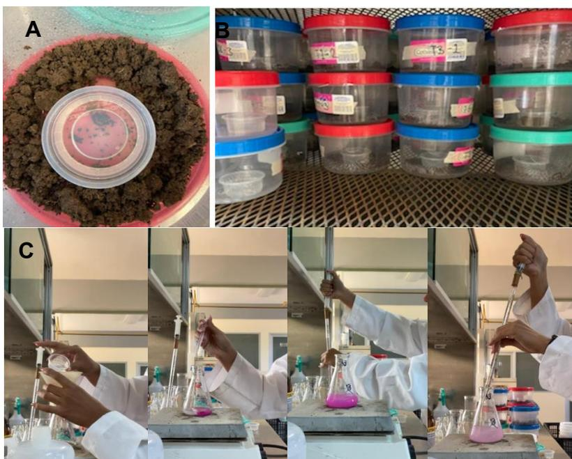
**Figura 17.** Muestra de suelo más cubeta con NaOH (A). Incubación de las muestras a 29 °C (B). Titulación de las muestras con HCl (C).
