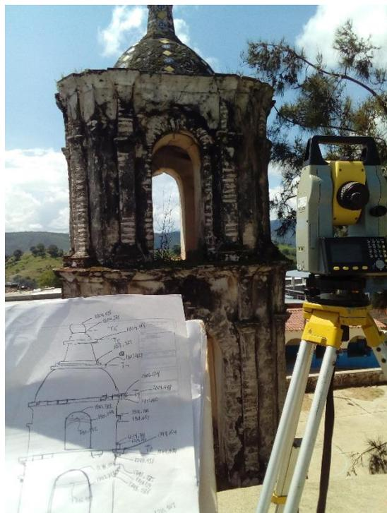
*Nota.* Proceso de medición con equipo sofisticado de estación total y dibujo de detalles en campo, dibujos generados por el investigador.
