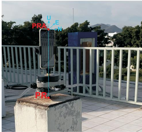
**Figura 5.24:** Xiaomi Mi 8 centrado verticalmente y nivelado sobre un monumento de centrado forzoso. Configuración de coordenadas ENU y orientación de la antena.
