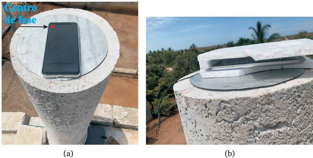
**Figura 5.7:** Teléfono inteligente Xiaomi Mi 8 sobre el disco metálico (plano de tierra) en el experimento 1: (a) sin protección térmica y, (b) con protección térmica.
