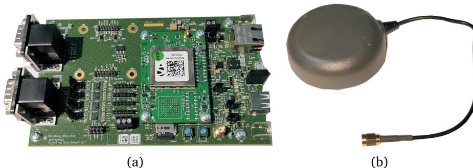
**Figura 3.2:** Receptor y antena GNSS utilizados: a) Mosaic-X5, y b) antena GNSS.
