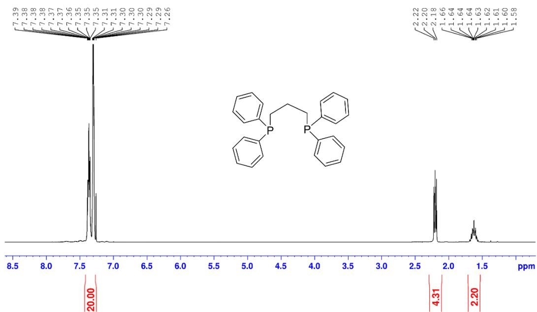
Figura A11. Espectro de RMN  $^1\text{H}$  de DPPP en  $\text{CDCl}_3$ .
