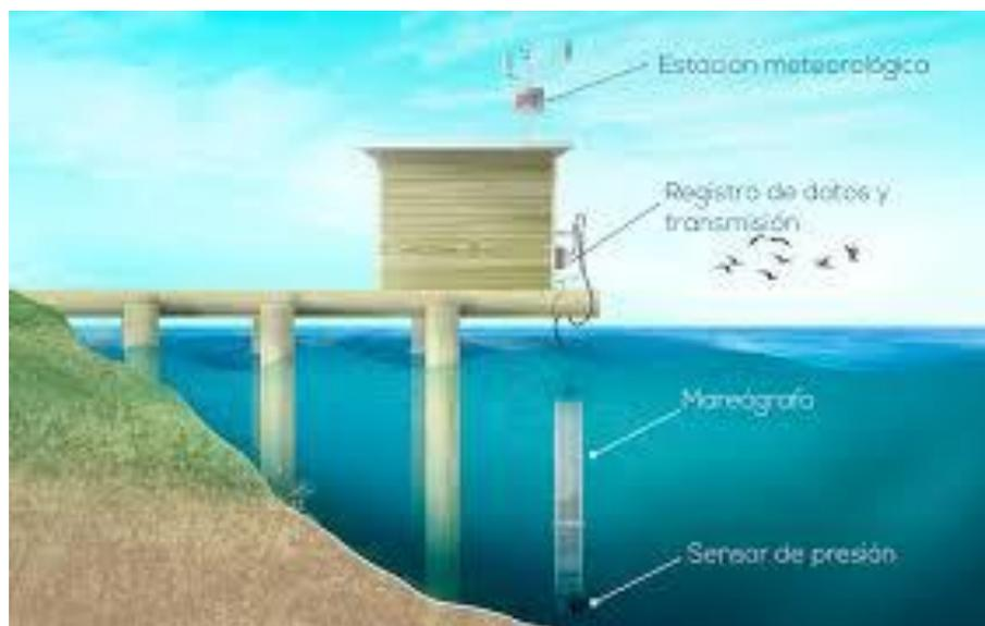
**Figura 13.** Mareógrafo de presión. Imagen cortesía de <https://slideplayer.es/slide/14115031/>
