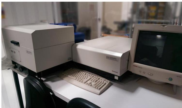
*Figura 15. Espectrofotómetro UV-VIS-NIR (IER-UNAM).*
