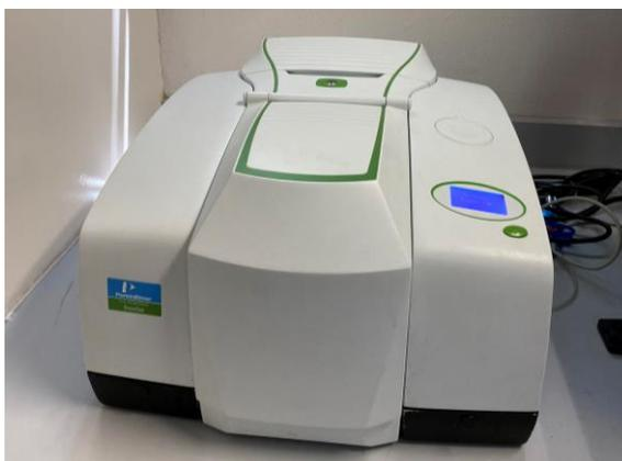
*Figura 12. Espectrofotómetro FTIR marca PerkinElmer modelo Frontier (Universidad de Sonora).*
