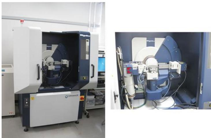
*Figura 14. Difractómetro de rayos-X Rigaku ULTIMA IV (Instituto de energías renovables, UNAM).*
